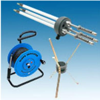
**Extensómetros**, usados para medir movimientos de tierra y roca a lo largo de un solo eje.
